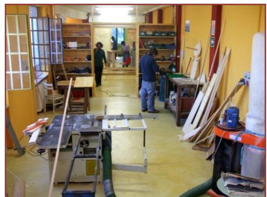
passaggio, anche sporadico, dell'utenza nei pressi del macchinario in funzione. Inoltre la falegnameria è dotata di un impianto di aspirazione di tipo professionale collegato alla combinata e dislocato all'esterno, raggiungendo così un soddisfacente abbattimento delle polveri derivanti dalle diverse lavorazioni.
